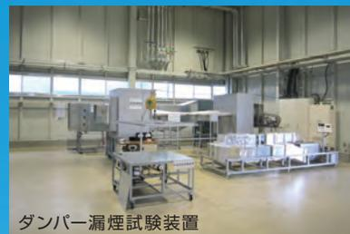
ダンパー漏煙試験装置
