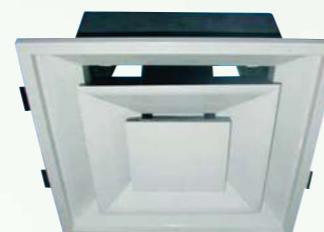
ND-STEC型に温度センサーを組み込んだオートタイプです。冷房時、暖房時にセンサーが吹出口温度を感知。自動で風向を制御します。
