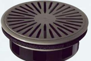
SKF型吹出口標準タイプのバスケットです。付属の取外し工具で吹出フェースを取り外して手動で風量調整ダンパーを動かし、風量を調整します。
