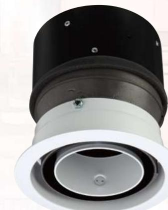
二重構造にしたノズルの間に天井内部の空気を誘引し、外筒への熱伝導を遮断することで、結露の発生を防止。さらに内側のテーパー筒表面に断熱シートを貼ることで、より結露防止効果を高めています。
