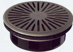
SKF 型吹出口標準タイプのバスケットです。付属の取外し工具で吹出フェースを取外して手で風量調整ダンパーを動かして、風量を調整します。
