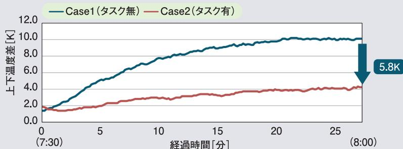
ケース2では上下温度差がケース1に対して5.8K緩和。暖房立ち上げ時にタスクファンを稼働させることで天井付近に溜まりにくくなり、暖気を居住域へと効率よく循環させることができます。暖房立ち上げ時間や上下温度差の緩和に有効であると考えられます。
