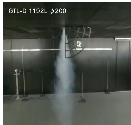
GTL 垂直(冷房) 風量：320CMH 温度：温度差 \Delta t=10^{\circ}\text{C}
