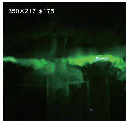
STE-MII 干渉(冷房) 風量：250CMH×2台 温度：温度差 \Delta t=13^{\circ}\text{C}
