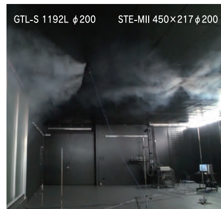
GTL-S 1192L インテリア・ペリ側気流(冷房) 風量：300CMH (STE-MII) 200CMH (GTL) 温度：温度差 \Delta t=13^{\circ}\text{C}
