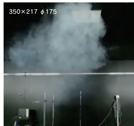
STE-MII 気流ドロップ(冷房) 風量：80CMH 温度：温度差 \Delta t=13^{\circ}\text{C}
