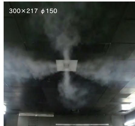
STE-MII 十字気流(冷房) 風量：180CMH 温度：温度差 \Delta t=10^{\circ}\text{C}
