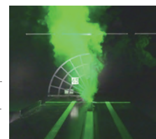
気流パターン④ 【気流角度：8°】
