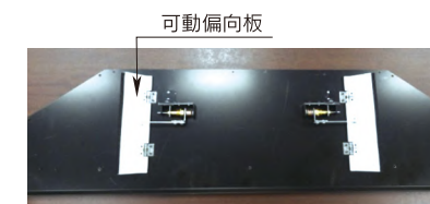
可動偏向板全体写真
