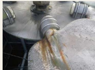
翼車の振動値が上昇している場合は、羽根角度調整不良、バランス調整不良などが考えられます。また羽根に亀裂が入っている場合もあり、そのまま運転を続けると大変危険です。
