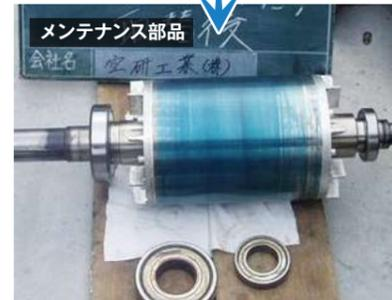
ベアリングの交換と分解整備を行います。劣化が進んでいる場合は、新品と交換します。
