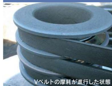
ベルトがスリップしファンの回転数が減り熱交換率が悪くなります。破断する場合もあります。
