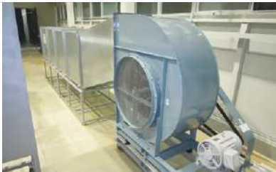
送風試験施設 ダンパー・VAVの送風試験が可能です。
