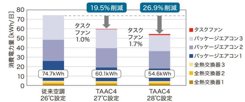
26°C設定の従来空調を基準とした空調システム全体の消費電力量は、27°C設定で19.5%の削減、28°C設定では26.9%の削減に。特に28°C設定では、省エネ性の面で大きな効果が期待できます。またタスクファンの稼働による消費電力量は2%程度となりました。わずか2%の電力で快適な空間を提供できます。
