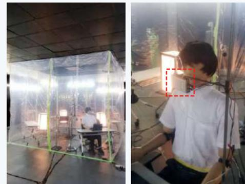
■トレーサーガスにはCO<sub>2</sub>を採用し、ダクト内部に9L/min注入。実験エリア内のCO<sub>2</sub>濃度が安定したら、実験終了としました。
