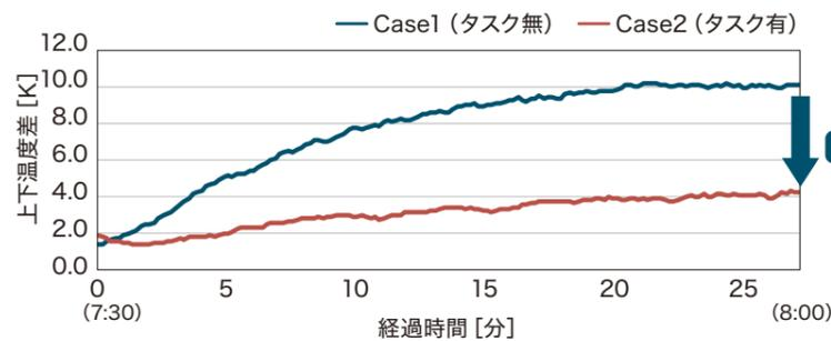
ケース2では上下温度差がケース1に対して5.8K緩和。暖房立ち上げ時にタスクファンを稼働させることで天井付近に溜まりにくくなり、暖気を居住域へと効率よく循環させることができます。暖房立ち上げ時間や上下温度差の緩和に有効であると考えられます。
