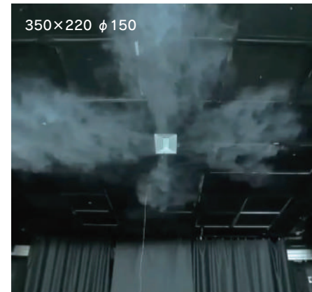
STE-MII 3方向吹出(長辺遮蔽) 風量：145CMH 温度：温度差 \Delta t=7^{\circ}\text{C}
