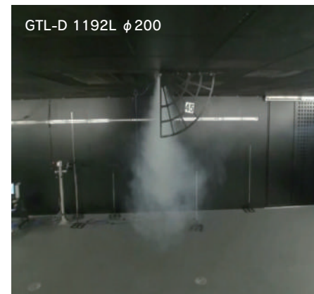
GTL 垂直(暖房) 風量：320CMH 温度：温度差 \Delta t=10^{\circ}\text{C}
