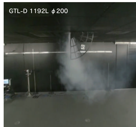
GTL 斜め15度(冷房) 風量：320CMH 温度：温度差 \Delta t=10^{\circ}\text{C}
