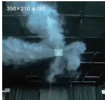
STE-MII 3方向吹出(長辺遮蔽) 風量：145CMH 温度：温度差 \Delta t=10^{\circ}\text{C}
