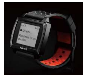
ウェアラブル端末 対象執務者の腕に装着 代謝量などを測定
