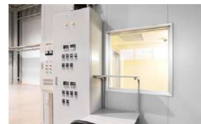
環境試験室 制気口の結露性能および材料の高温多湿環境を測定します。
